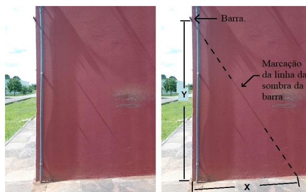
Figura 1 – A esquerda, uma foto das sombras formadas na parede. A direita, a posição da barra, sua sombra projetada e as referências das medidas utilizadas para determinação do ângulo de inclinação.
