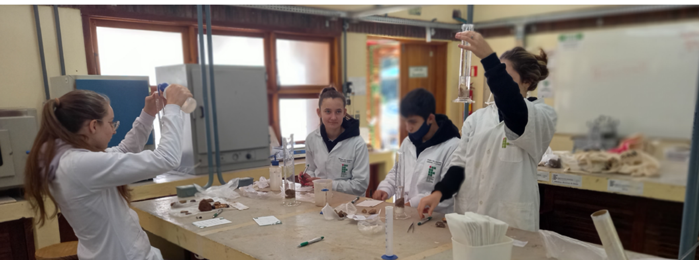
📍 Figura 3. Alunos determinando a densidade dos minerais pelo método de Arquimedes (deslocamento de volume). Fonte: Próprio autor (2022).
