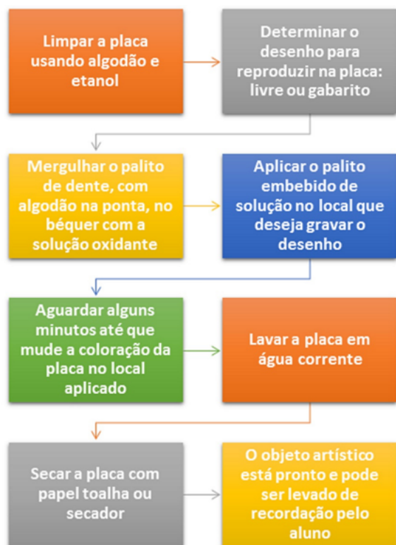
🔍 Figura 3. Passo a passo para reproduzir o desenho na placa metálica pela reação de oxidação. Fonte: Próprios autores (2019).
