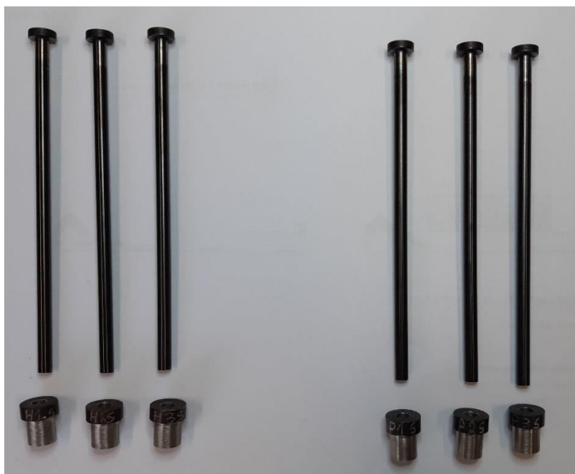
Figura 3 – Conjuntos Pino/Bucha antes do ensaio de desgaste.
