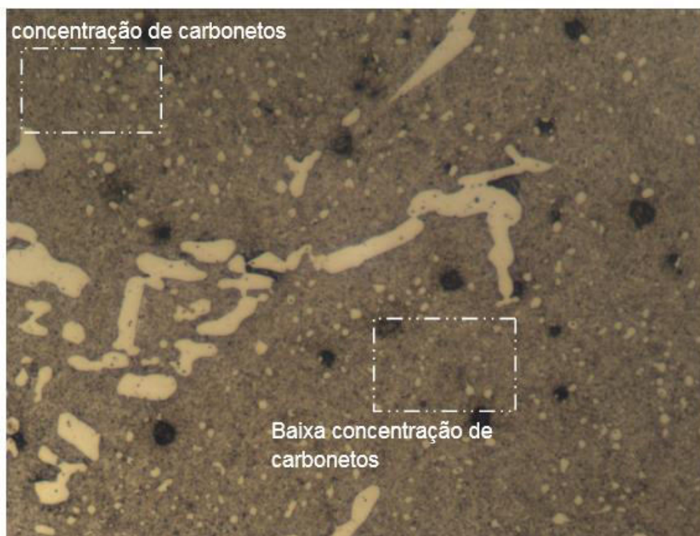
Figura 6 – Face superior da matriz fraturada com ênfase em má distribuição de carbonetos (400x).
