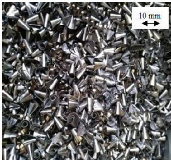
Figura 4: Cavacos de aço SAE 1045.
