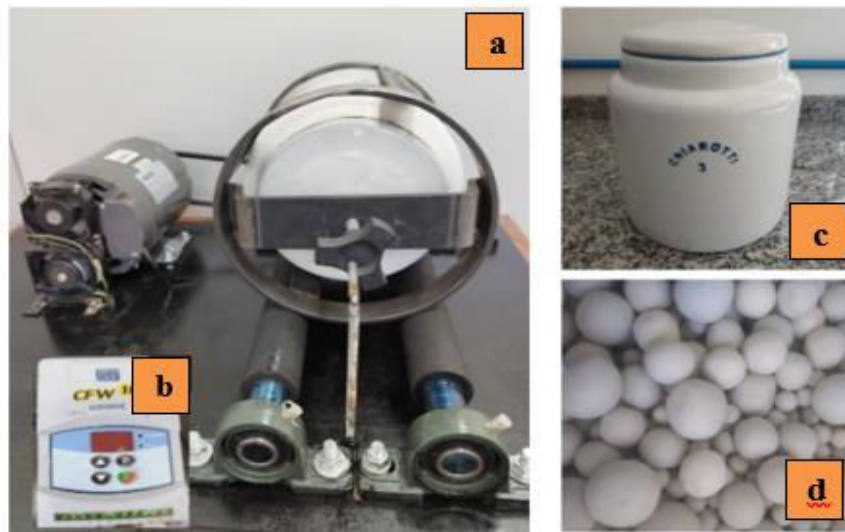
Figura 6: Equipamento utilizado para moagem: Moinho de bolas (a) e controlador de velocidade (b); Jarro cerâmico (c); Bolas cerâmicas (d).
