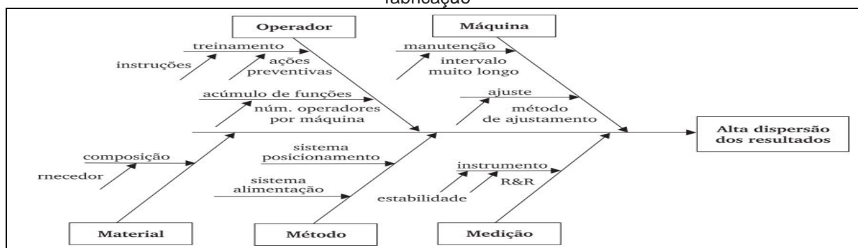
Figura 7 - Diagrama de causa e efeito: causa para alta dispersão do resultado de um processo de fabricação
