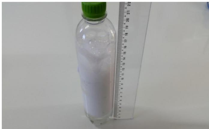
**Figura 2:** Medida da altura da coluna de espuma formada.
