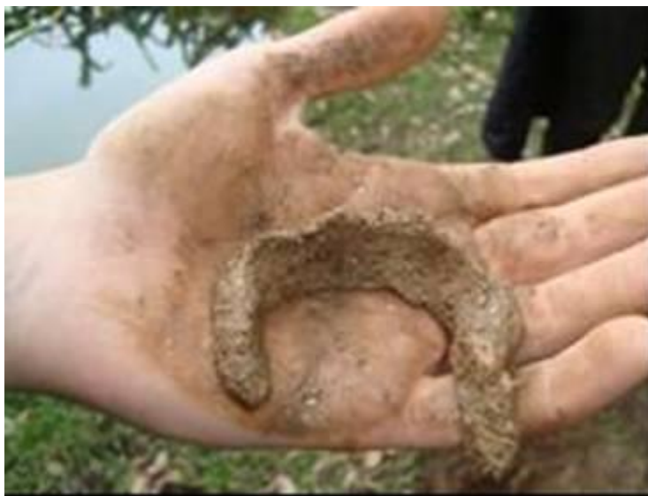
Figura 3. Rolo curvo de amostra de solo, formado para determinar sua friabilidade e sua plasticidade.
