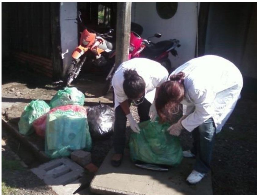
Figura 5 - Pesagem da fração de resíduos sólidos retirada para amostragem. Fonte: Os autores (2013).
