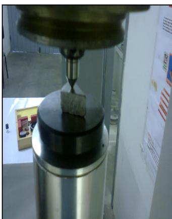
Figura 3: Detalhe da amostra sofrendo a ação do penetrador (esfera de aço de diâmetro 1/16”).
