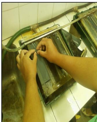
Figura 4: Amostra de metal ferroso sendo lixada em processo manual por uma lixa de 400 mesh.
