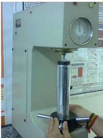
Figura 2: Amostra não ferrosa sendo ensaiada no durômetro em escala rockwell B.
