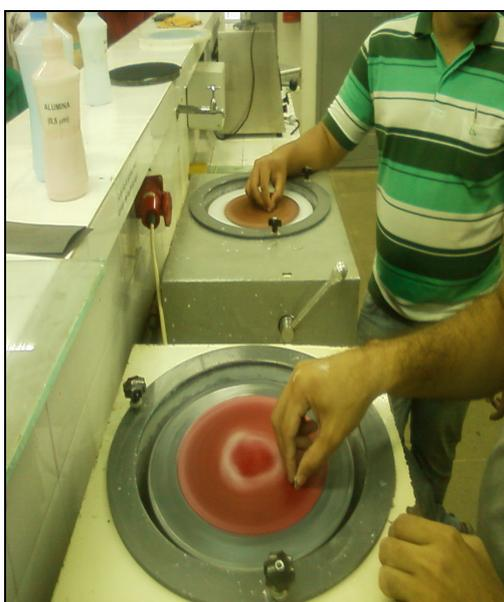
Figura 5: Processo de polimento das duas amostras em diferentes máquinas com alumina em suspensão de 0,5  $\mu\text{m}$ .
