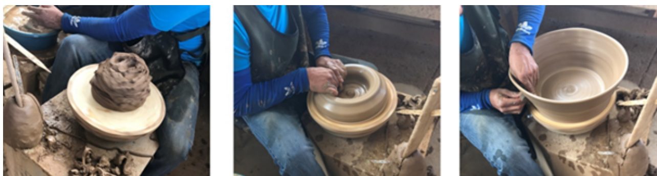
Figura 3 – Processo de produção de vasos artesanais da Cerâmica da Serra da Capivara
