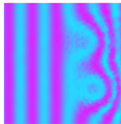
Figura 4 – Padrões de difração refração para o caso do fundo marinho com dois picos perto de linha costeira
