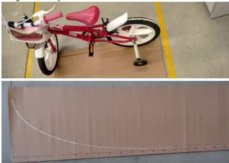
Figura 5 – Posição inicial da bicicleta e rastro deixado da roda traseira.
