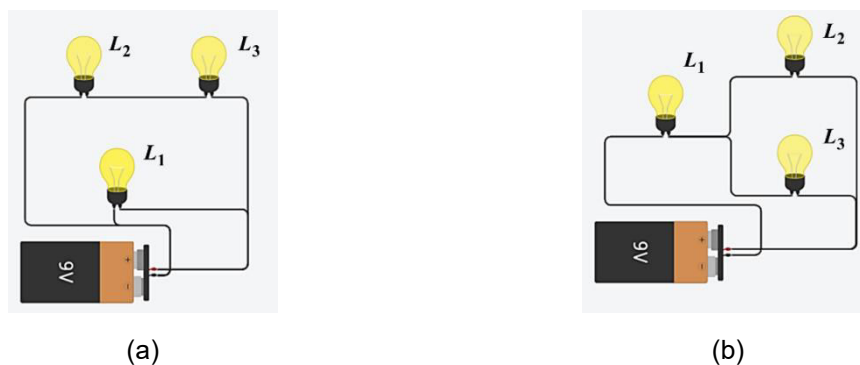
Figura 12: Experimentos virtuais elaborados no Tinkercad para associações de lâmpadas idênticas alimentadas por uma bateria de 9 V por meio de fios condutores: (a) ligação mista com L_1 conectada em paralelo com L_2 e L_3 , que estão em série, e (b) ligação mista com L_1 conectada em série com L_2 e L_3 , que estão em paralelo.
